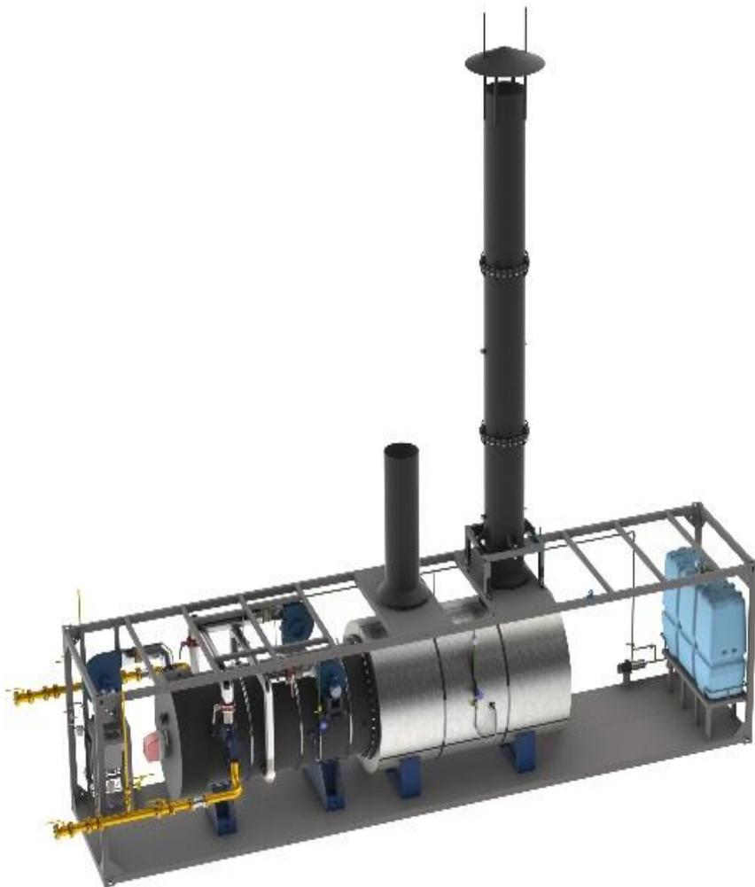
Установка ГЭС ЭТ-300 предназначена для обезвреживания свалочного газа, в том числе биологического газа с теплотворной способностью 23000÷26000 кДж/м<sup>3</sup> по заданному температурному режиму с избытком атмосферного воздуха.
